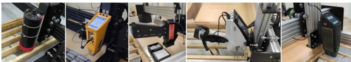
Рис. 1. Примеры используемых измерительных инструментов в комплексе GeRDA (слева направо: «Спектроскан ГЕО», Olympus Vanta, oreXpress, Bruker Tracer, SciAps X550)
